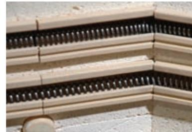
Fotos del sistema de elementos de tipo Quad
