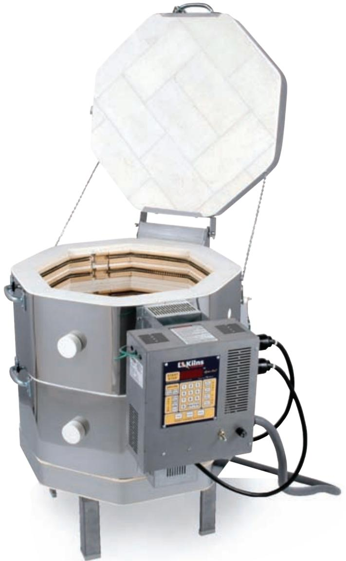
Los hornos JH son diseñados específicamente para la quema del vidriado cristalino. Tienen el ladrillo refractario especial de alta temperatura para la quema hasta el cono 12, la energía extra para la calefacción rápida, los elementos super-reforzados para durar los rigores especiales de la quema cristalina, el aislamiento mínimo para permitir el enfriamiento rápido y los termopares de Tipo S para la vida más larga.
