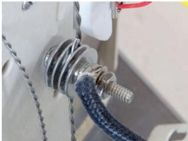
**HEAVY-GAUGE TYPE K THERMOCOUPLES**
